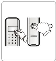
采用任意方式正确开锁（密码和机械钥匙除外）或取下电池，都可以解除键盘锁定。
