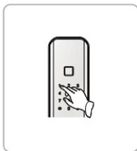
连续3次输入错误密码，键盘将自动锁定，按任意数字键都会提示“键盘已锁”，约15分钟后自动解锁。连续输入错误密码未达3次，约2分钟后自动清除错误次数。
