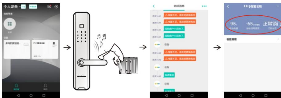
设备入网成功，给锁上电时，阿里智能APP有电源重启的推送消息；电量低于40%时，阿里智能APP有更换电池报警的推送消息。锁端每次上报消息都会带上电池电量的消息，阿里智能APP收到消息后会及时更新电量数值。阿里服务器也会从接收的数据中解析信号强度，更新阿里智能APP上的信号强度数值。
