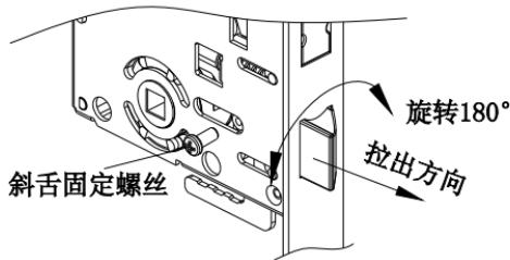
(2) 如图：安装锁芯前，需用工具调整好锁芯孔位置，方便安装前/后锁体。
